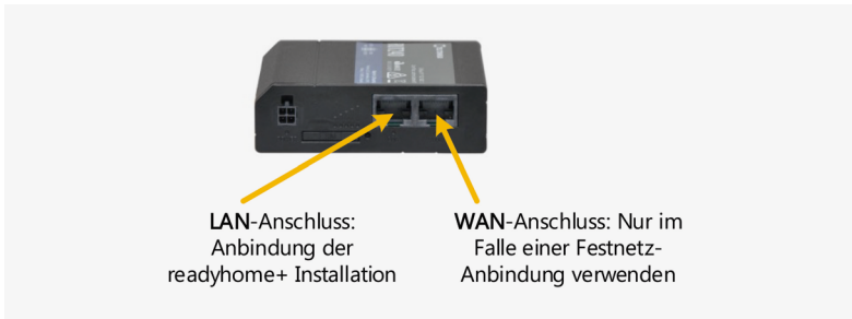
Abbildung 8: Anbindung Router RUT 240
